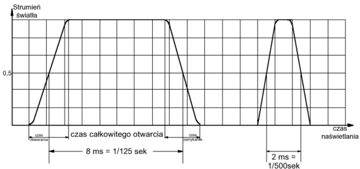
Wykres zależności strumienia światła od czasu otwierania i zamykania migawki centralnej
