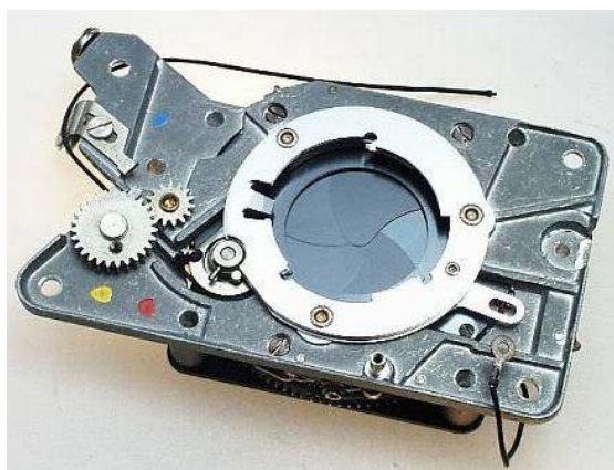
Migawka centralna Prontor 500 1968r sterowana elektronicznie
