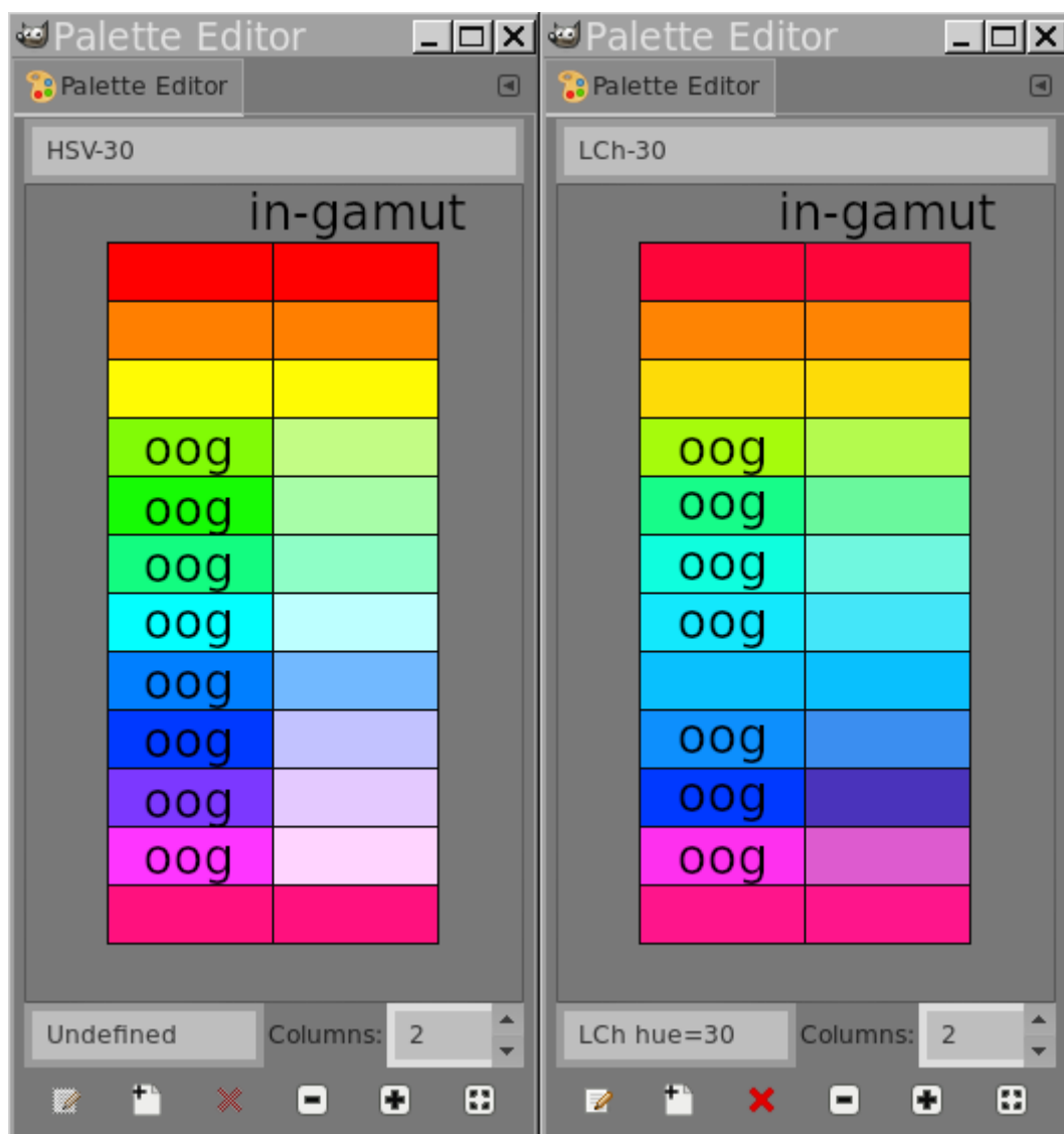
Rys. 5 Obniżenie nasycenia HSV dla kolorów na kole kolorów HSV, a obniżenie LCh Chroma dla kolorów na kole kolorów LCh, aby pozbyć się kolorów poza gamę kolorów drukarki Epson P9000 podczas drukowania na papierze Museo Silver Rag:
