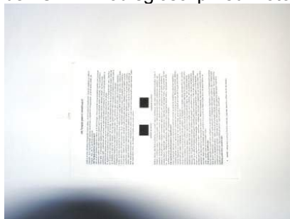
Rys 008c Test cienia dla trybu Macro z CLA-4 i odległości przedmiotowej 60cm, flesz ⚡ światło dopełniające Wyniki testu cienia obiektywu w trybie Tele przy stosowaniu soczewki +4D i flesza - (dla odległości przedmiotowej ok. 250mm i ogniskowej 100 i 250mm) ustawianie ostrości SPOT - brak cienia.
